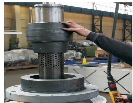
Montagem de Válvula By-Pass de Turbina
