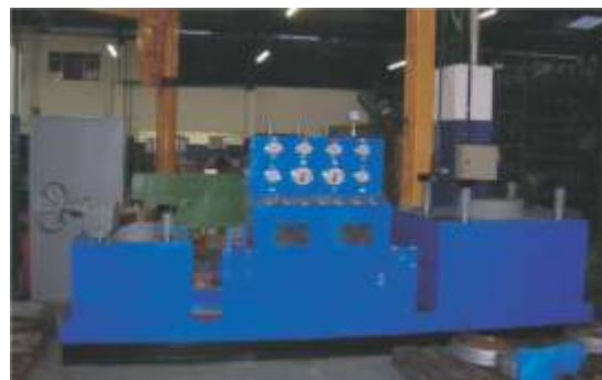
Bancadas automáticas para testes para válvulas até DN 2000mm
