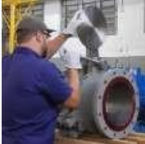
3.1 Desapertar em sentido anti-horário, os três parafusos utilizando a alavanca fornecida com cada válvula, para retirar o aperto dos flanges contra o disco.
