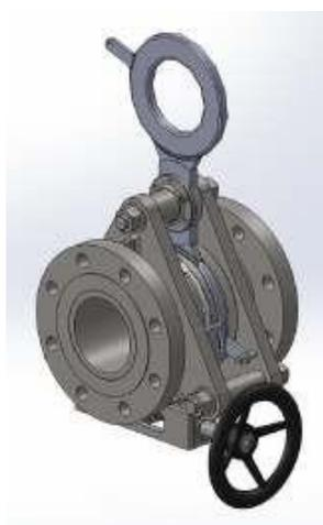
Este modelo permite a operação por uma só pessoa de forma rápida e segura. Neste modelo a distancia entre os flanges da tubulação permanece inalterada durante a operação. Um conjunto de cames acionados pelo volante manual permite a movimentação dos elementos internos de vedação para permitir a rotação da placa móvel. O operador pode fazer o bloqueio ou a abertura em menos de um minuto.
